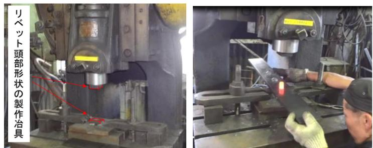
図 - 2 模擬リベット製作状況
