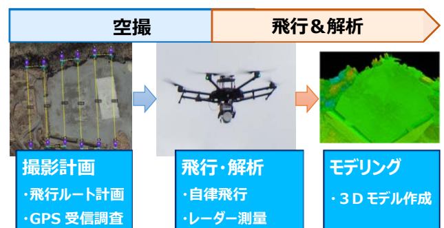
図-2 空中レーザー測量の流れ
