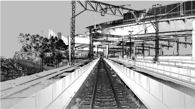
図-2 3D 計測器で取得した3 次元点群データ
