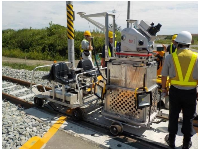
写真-1 技術開発したトロ台車（右）と軌道自動自転車（左）
