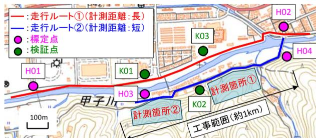
図-1 走行ルートおよび標定点・検証点配置図
