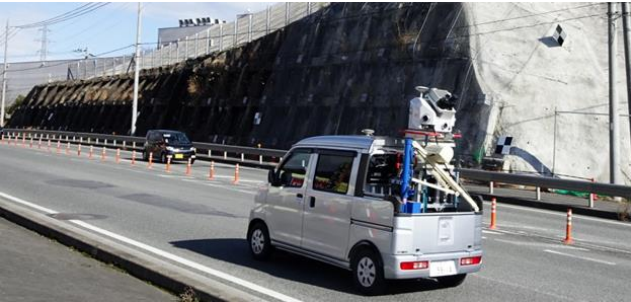
図-1 MMSによる法面計測イメージ図
