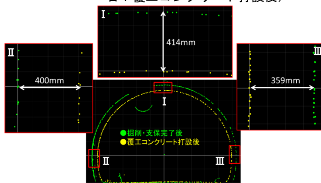
図3 掘削・支保完了後と覆工コンクリート打設後のMMS点群の重ね合わせ(50m地点)
