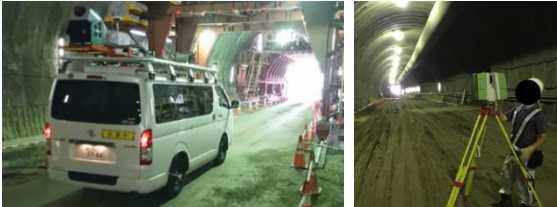
図 1 計測状況（左：MMS，右：TLS）
