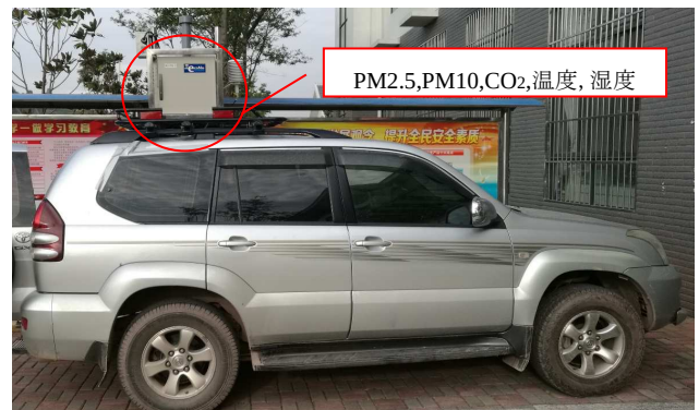
図-4 車載式移動型大気環境計測システム
