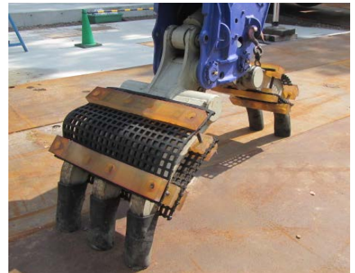
図3 緩衝材取付状況
