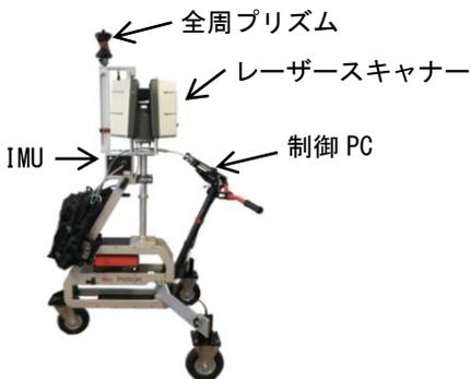
図-1 地上移動体搭載型 TLS
