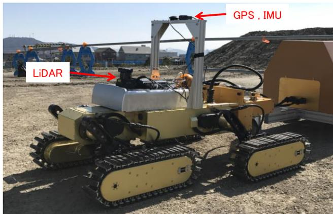
写真2. マルチクローラ型移動ロボット“健気”
