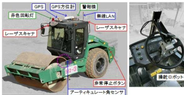
写真-1 自動化振動ローラ
