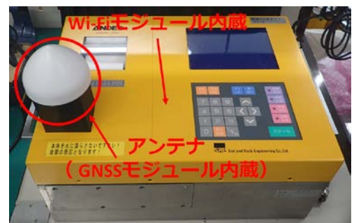
写真-2 測位機能搭載 RI 密度水分計
