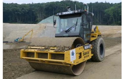
写真-1 自律制御型振動ローラ
