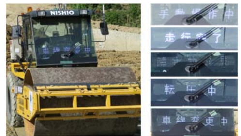
図-6 電光掲示板による機械状態表示
