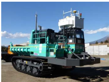
図-1 開発中の遠隔操作型半水中クローラダンプ
