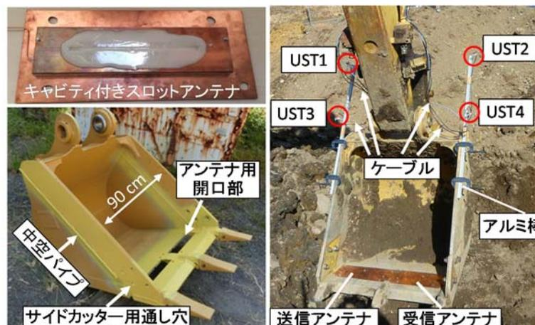
Fig. 3 アンテナ、及び一体型バケツの概要
