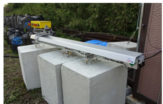
図-3 レーダアンテナの設置状況
