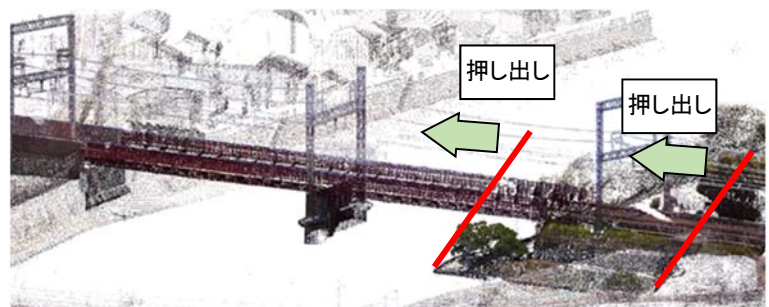
図-3 レーザースキャナによる点群データ
