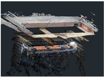
熱供給管が再現できた (デジタルカメラ, 四隅 GCP, 撮影夜)
