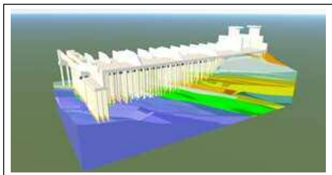
図－3 中間堰3次元地層モデル
