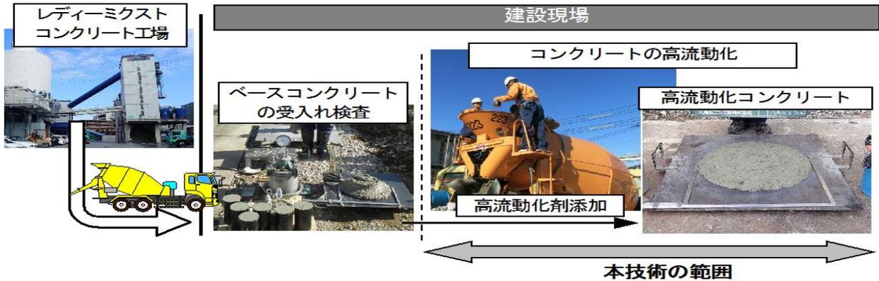
図-3 奥村式現場添加型高流動コンクリート イメージ図
