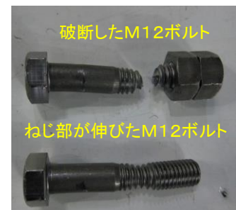
図7 ボルトの破壊状況
