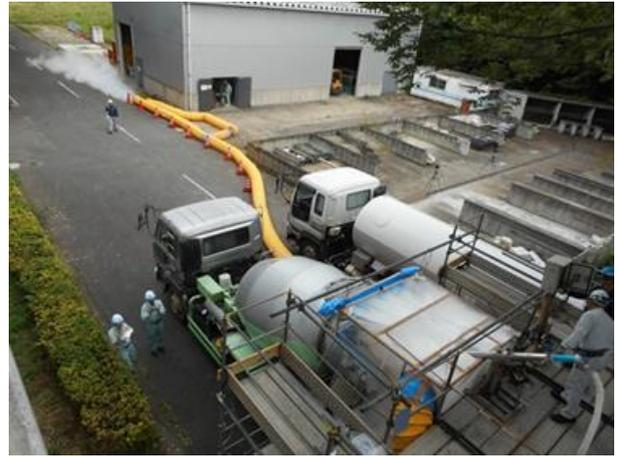
写真-2 回収・搬送装置を用いたクーリング状況
