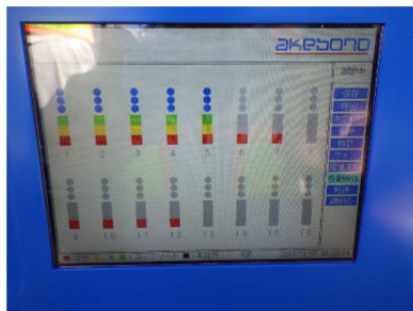
写真-4 充てん・締固め確認状況
