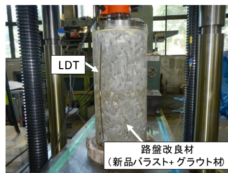
図2 一軸圧縮試験の状況
