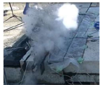
写真-6 爆裂の状況
