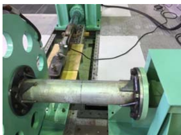
写真-4 鋼管トルク試験状況
