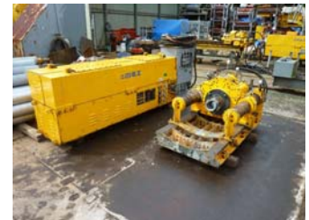
写真-2 使用した小口径推進機
