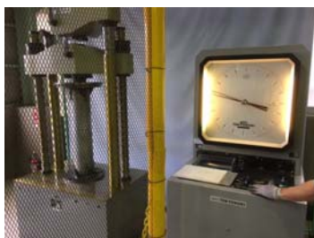
写真-3 鋼管圧縮試験状況
