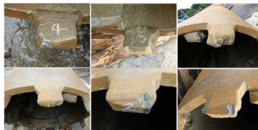
写真-3 外爪損傷状況
