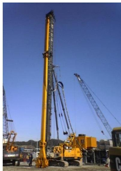
写真-2 CSM機(CSM-5型)
