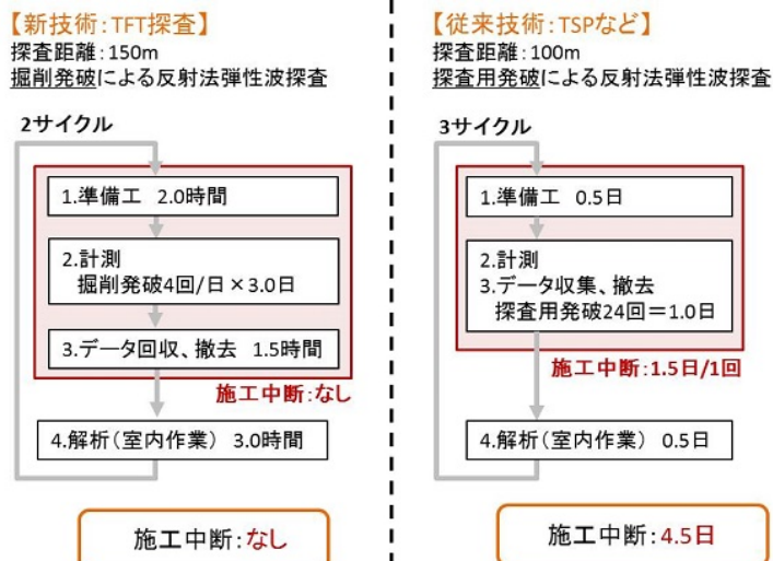
図-1 反射法弾性波探査のフロー（300m連続探査の場合） 7)
