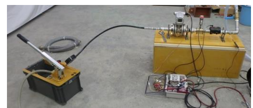
写真-1 耐圧試験の状況
