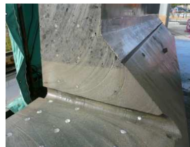
写真-4 供試体内部充填状況
