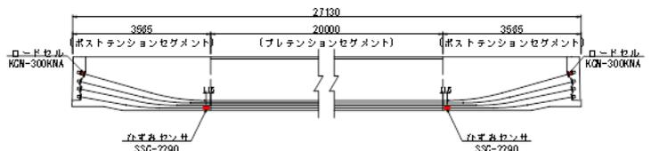
図-5 緊張力計測機器配置図
