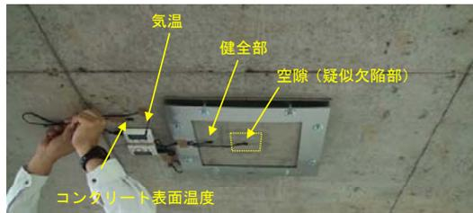
写真-2 熱環境測定装置設置状況
