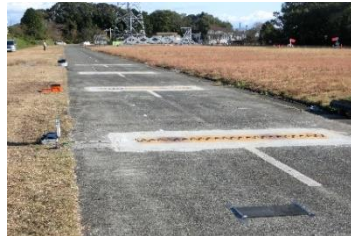
図 3 テストコース上の試験体とセンサ
