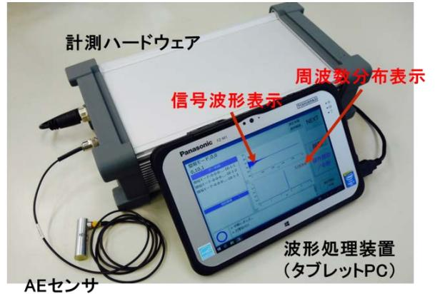
図 1 AE センサを用いた打音検査装置
