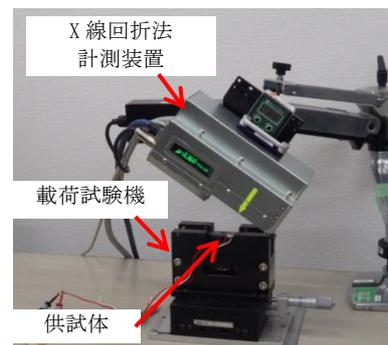
図1 計測装置および载荷試験機
