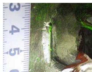
図-6 磁粉探傷試験結果
