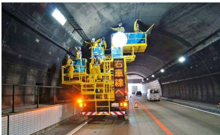
図-1 新型専用作業車（E-マルチ点検車）
