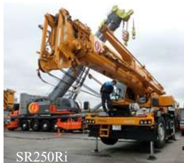
図-2 25t 吊ラフテレーンクレーンとセンサ設置の様子
