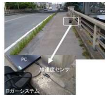
図-3 扇橋とセンサ設置の様子
