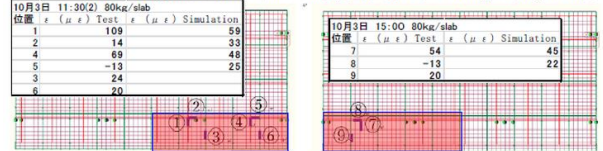
図4 載荷ケースとひずみ計測・解析結果
