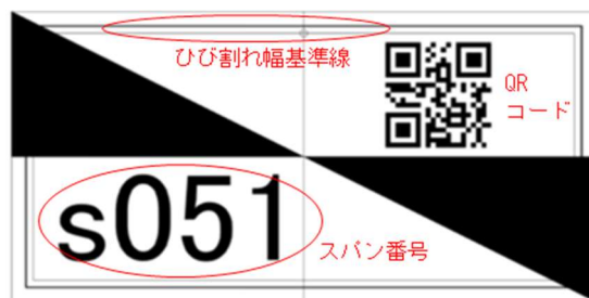
図 1 トンネル覆工マーカ
