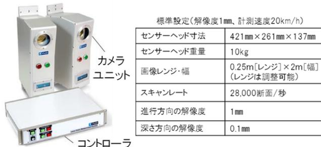
図2 計測装置の外観と主な仕様
