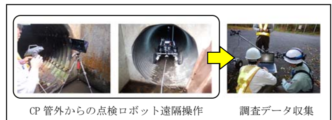
図-2 CP 点検ロボットによる調査状況
