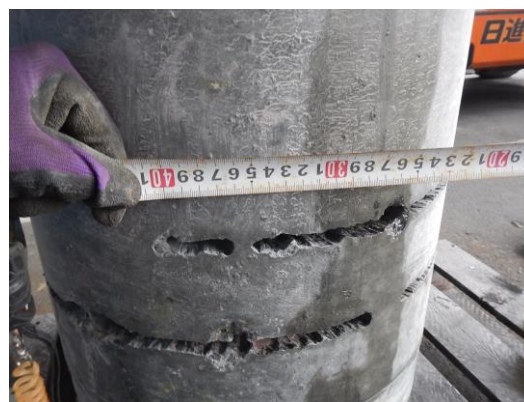
写真-2 試験施工後のコンクリート杭の切断面
