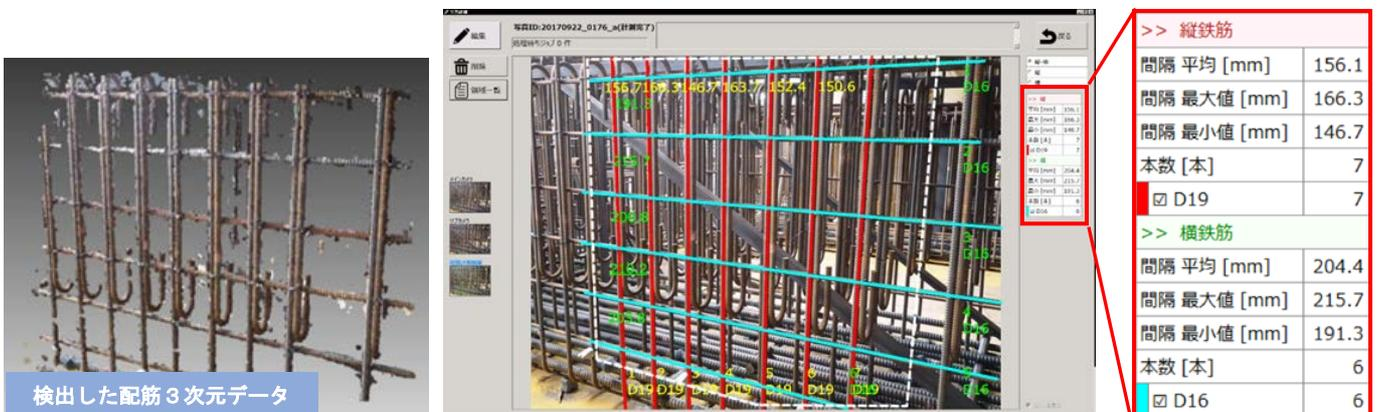
図-3 3次元データと自動計測結果
