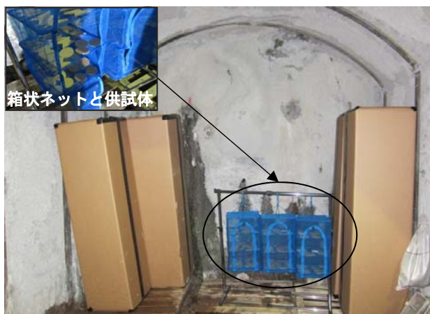
写真-3 供試体および箱状試験体の静置状況
