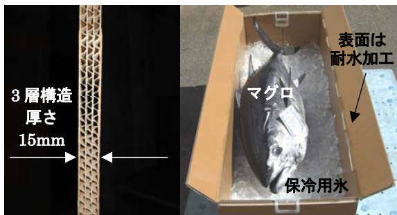
写真-1 紙素材の概要および使用例(マグロ輸送)
