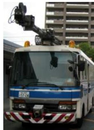
図-1 路面計測車
