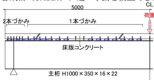
図-5 大型模型載荷試験（半断面図）と実験条件
