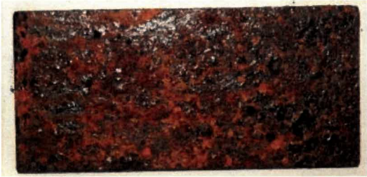
図-1 作製した腐食鋼板
